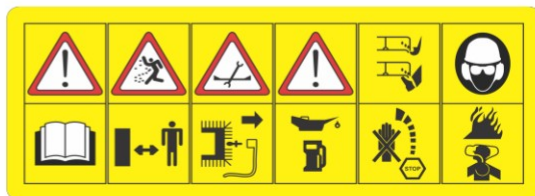
2. Ábra. Biztonsági matricák, melyek a gépezeten találhatók
