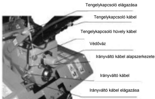
6. Ábra – Tengelykapcsoló kar felszerelése és beállítása
