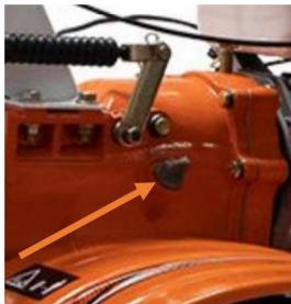
Füge. 5 – A sebességváltó olajszintjének ellenőrzése
